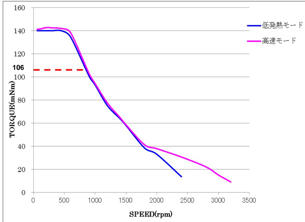
電源電圧48V のときのトルク特性
