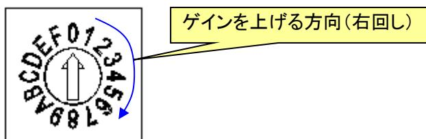
$$\text{設定後の比例ゲイン} = \text{ベースゲイン}(PKv, VKv) \times (\text{スイッチのポジション値} \times 0.5 + 1)$$
