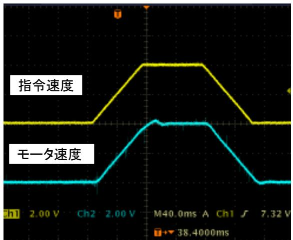
Fig5. 比例ゲインを上げすぎて定速部にリングングが見られるスイッチ“P”的値を小さくしてください。
