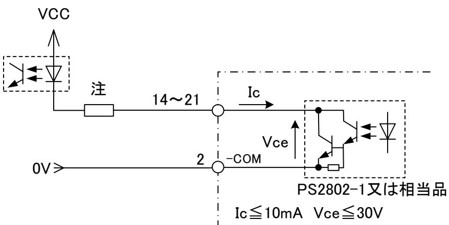
注)出力フォトカプラの飽和電圧1Vtyp(出力電流が10mA時)を考慮して制限抵抗値を決めてください
