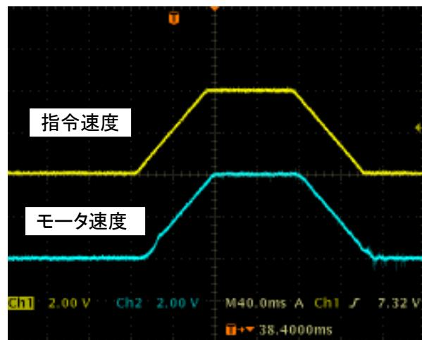
Fig2. 比例ゲインが大き過ぎてモータ速度が振動している。スイッチ“P”的値を小さくしてください。
