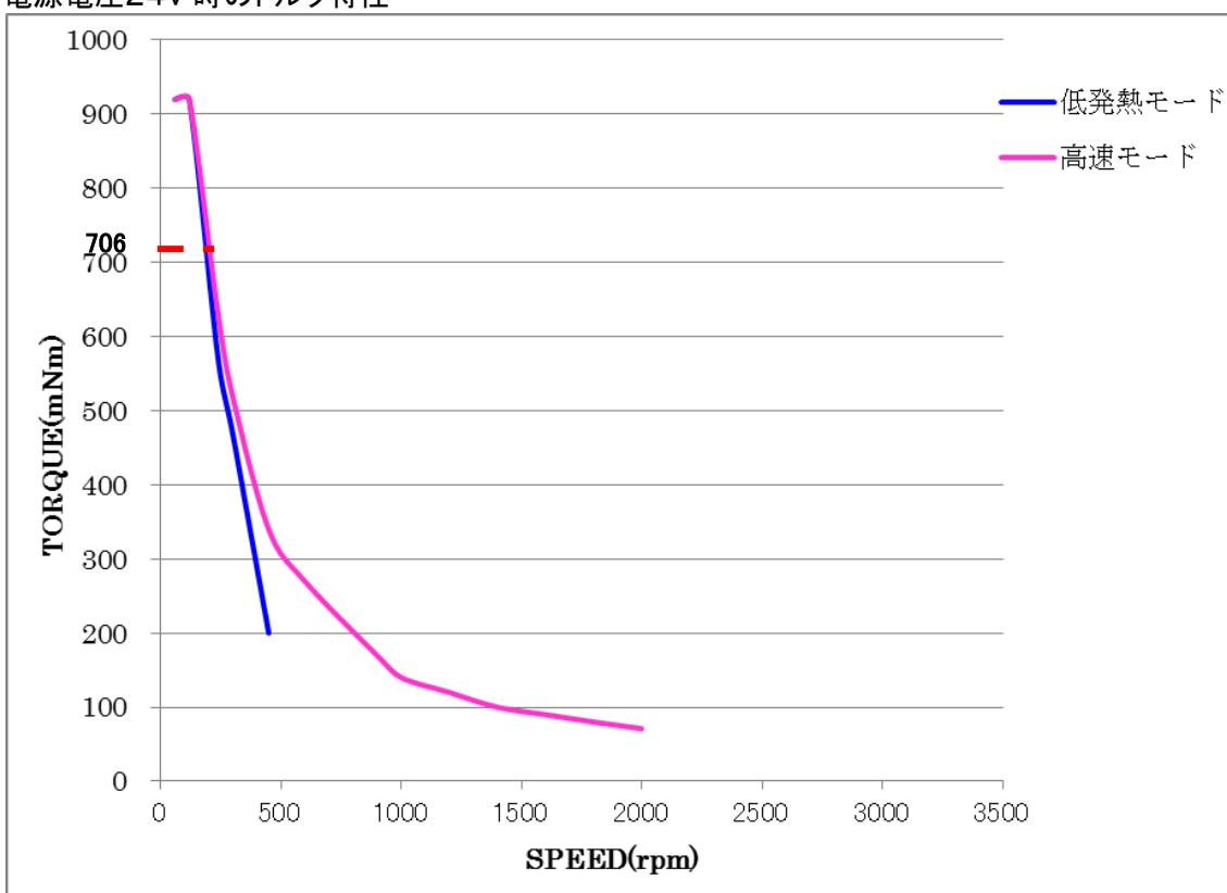
電源電圧48V 時のトルク特性
