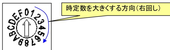
$$\text{設定後の積分時定数} = \text{ベース時定数}(PTv, VTv) \times (\text{スイッチのポジション値} + 1)$$
