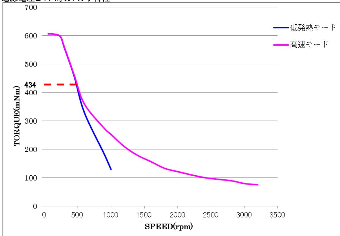
電源電圧48V 時のトルク特性
