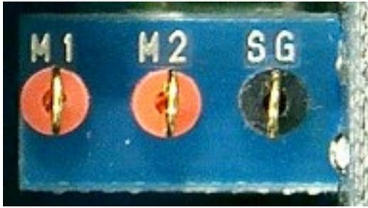
前面のチェック端子でモータの動作状態を観測できます。観測可能な波形は指令速度、トルク指令、モータ速度、モータトルク、位置偏差、インポジションとなります。
