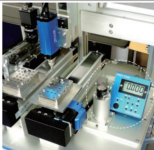
※PRO-CHK 搭载例（照片为本公司锁螺丝机器手臂「PRO-ROBOT」。
